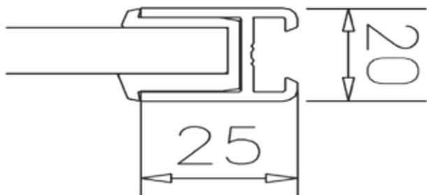
Exemple de section transversale du profil TK20 (larg. 20 mm)
