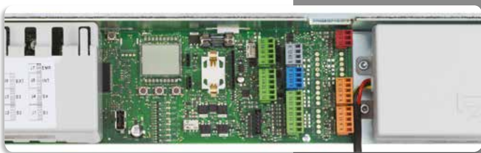
UNITÉ DE CONTRÔLE AVEC PLATINE D'ALIMENTATION SWITCHING
