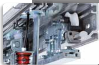
CHARIOTS DE COULISSEMENT Chariots avec roues de coulissement dans un matériau synthétique sur roulement et renforcé pour les versions à double moteur. Coulissement sur rail en aluminium anodisé intégré au profil.
