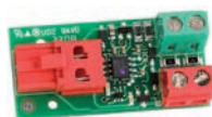
Interfaccia BUS XIB (per scheda E045S o E045S con fotocellula no BUS)
