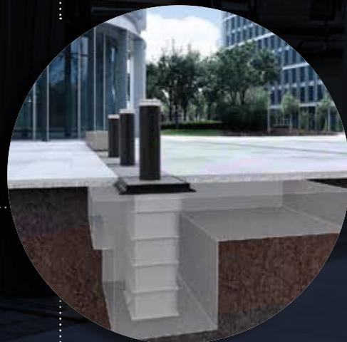
Vista in sezione di un sistema completo composto da dissuasore, pozzetto di alloggiamento e fondazione rinforzata.
